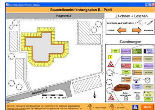
Abb. 3: Baustelleneinrichtungsplan B - Profi
