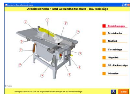
Abb. 2: Arbeitssicherheit und Gesundheitsschutz – Baukreissäge
