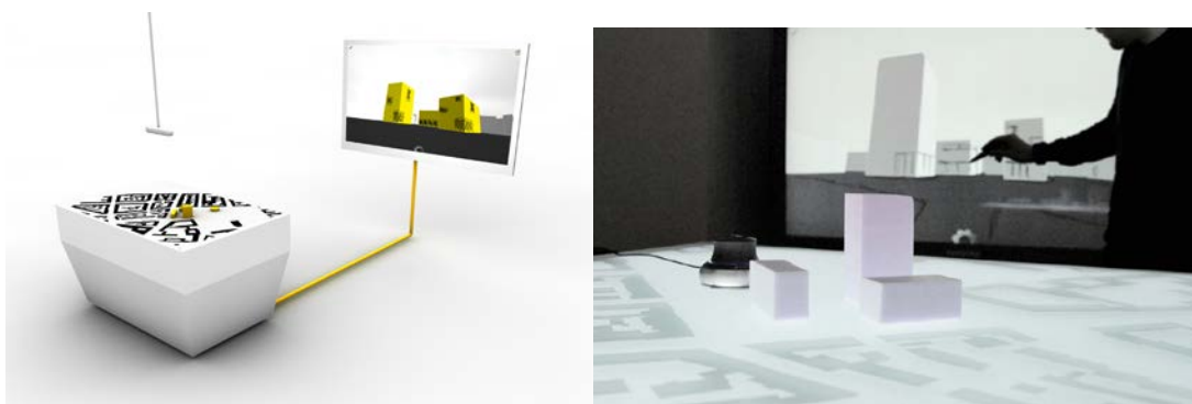
Abbildung 1: Systemaufbau – Modelle werden auf dem Multi-Touch Tisch eingescannt und mit dem 3D Skizziertool im Hintergrund verlinkt
